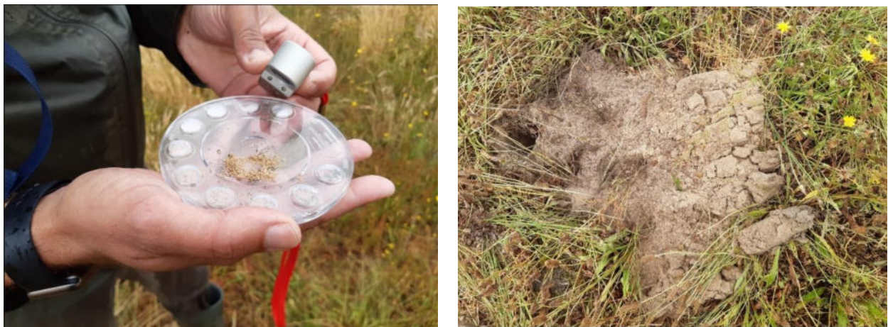
Figuur 2.1. Links matig tot zeer grof zand: 210 \mu\text{m} tot 420 \mu\text{m} (80%) en uiterst grof zand van 0,42 mm tot 2 mm (20%) tot minimaal 120 cm diep. Rechts boorgat tot een diepte van 120 cm droog (tot 40 cm stofdroog).
