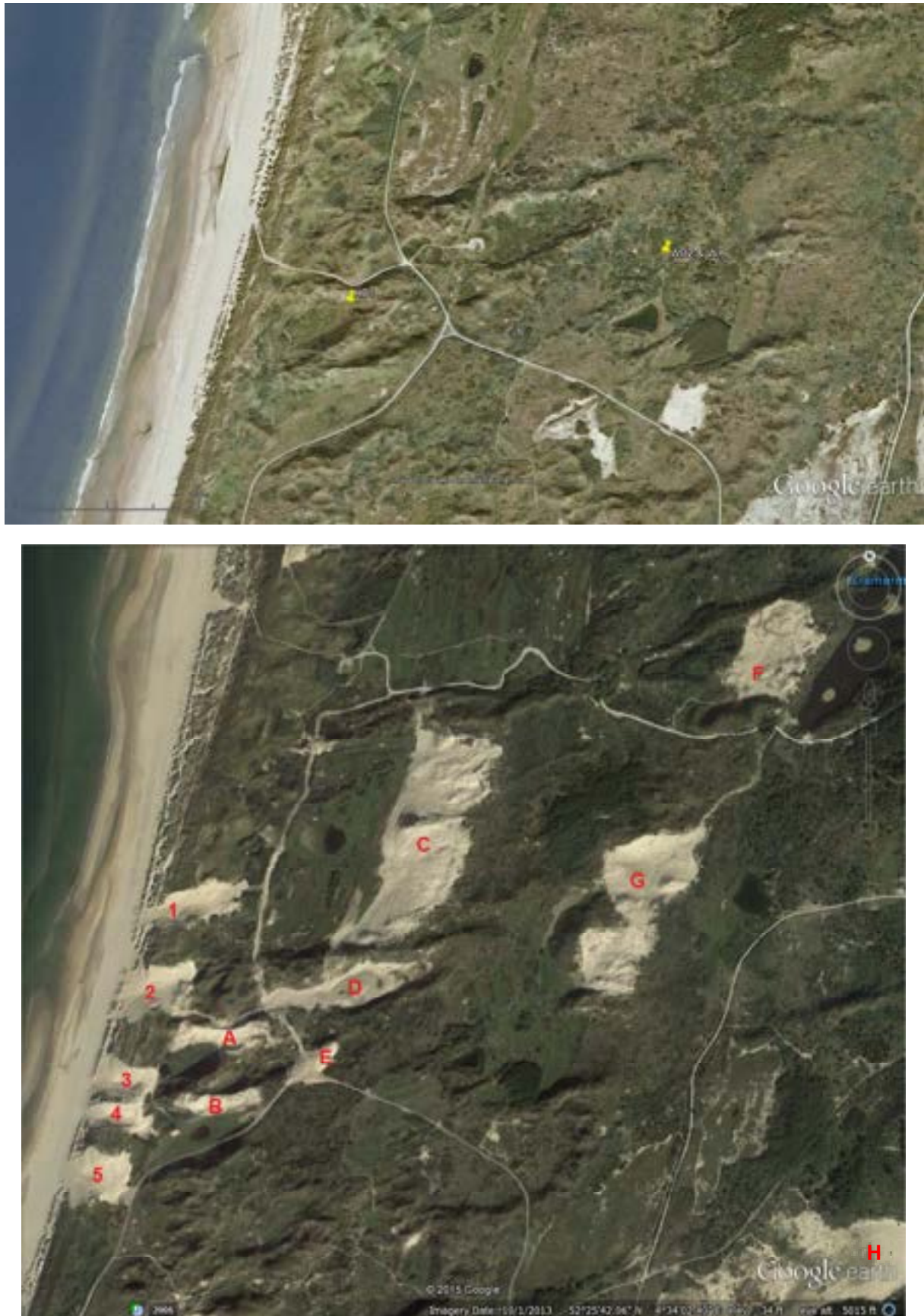
Fig. 1.4. Situatie vóór de ingrepen (boven; 1 jan. 2005) en na de ingrepen (onder; 1 oct. 2013). 1-5 = kerven in zeeleep; A-G = duinen gestript van vegetatie en bodemprofiel in periode 2012 – 2013; H = omstreeks 2005 geplagd duin.
