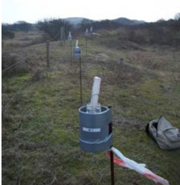
FIG. 2.4. Een zeezoutvanger (Salt Interception Device, SID) op de omheinde meetlocatie Wieringen. De vanger bestaat uit een grijze plastic cilinder die een glazen potje huisvest, met daarin een glazen testbuis omwikkeld met een katoenen kous. Foto door Stuyfzand.
