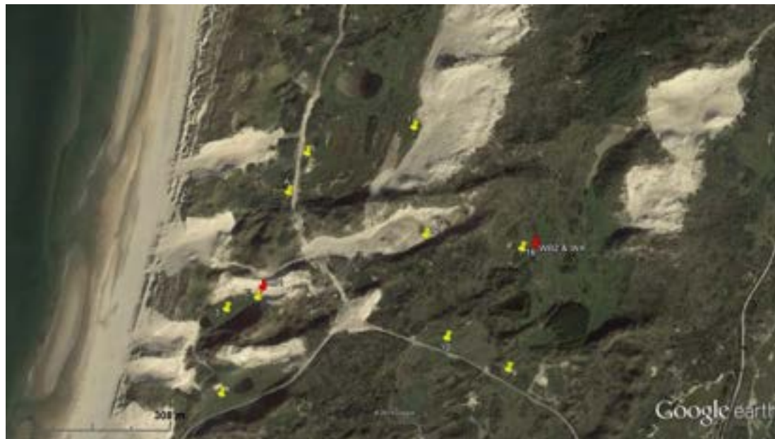
FIG. 8.8. Locatie van schroefboringen (gele pin) die in zowel september-oktober 2011 (vóór de ingrepen) als april 2014 (1 jaar na de ingrepen) en juli 2015 (2.3 jaar na) zijn bemonsterd (naar Buitink 2014). De rode pin geeft de locatie van de 'permanente' bulk regenvangers aan. Profiel A werd alleen in 2014 opgenomen. Profiel 17A bevindt zich rechts van de rechter figuurrand (zie Fig.2.11).
