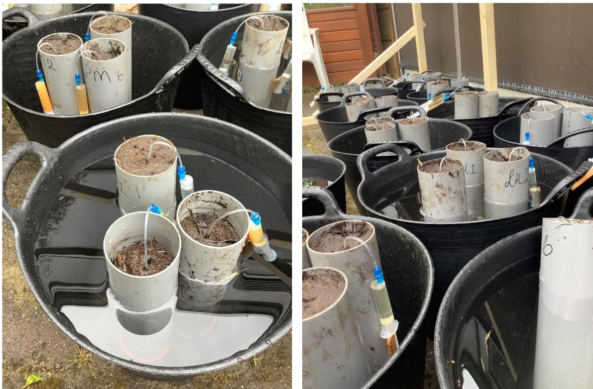
Figuur 3. Vaten met veenkolommen, met rhizons en spuitjes voor de bemonstering van poriewater.
