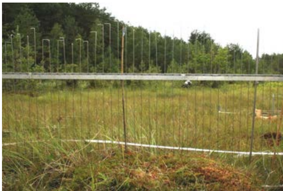
Foto 14: Een pinframe met 5 cm horizontale resolutie werd gebruikt om hoogteverschillen binnen het transect in te meten.
